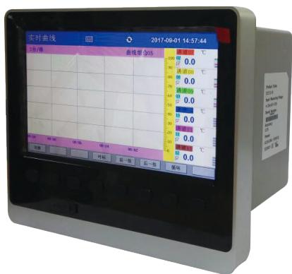
MTC多通道数字显示控制器1~48路万能输入（可组态选择输入：标准电压、标准电流、热电偶、热电阻、毫伏等）。可带18路报警输出或12路模拟量变送输出，RS232/485通讯接口，以太网接口，微型打印机接口和USB接口，SD卡插座；可提供传感器配电；具有强大的显示功能，实时曲线显示，历史曲线追忆，棒图显示，报警列表显示等。人性化的外观设计、完美的功能体现、可靠的硬件品质、精湛的制造工艺，具有更高的性能价格比。
