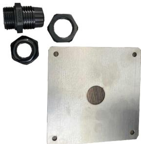
在相当情况下，电源接线盒等无法直接安装在管道或者设备上，因此伴热线或者温度传感器信号线需要穿过保温层接入接线盒，存在着被保温材料最外层金属外壳割伤的风险，因此在此情况下，在伴热线本体、冷端或者其他信号线穿出保温材料最外层的金属外壳上预制相关的保温层衬套，以保护线体安全。
