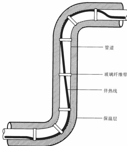
管道通过吊架部分电伴热带的安装
