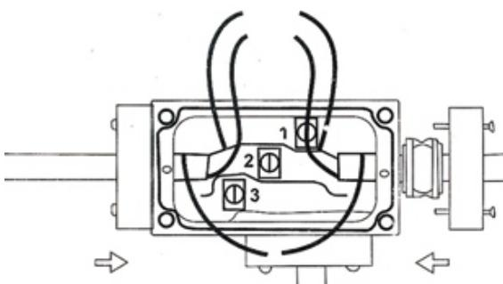
将一号及二号电缆的垫圈垫入盒内并固定，拧紧螺钉交压板固定。
