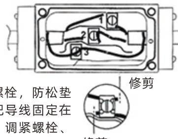
放松螺栓，防松垫圈及压板把导线固定在接线板上，调紧螺栓、防松垫圈及压板固定，剪掉多余的导线。
