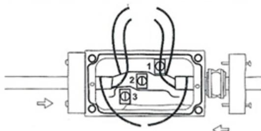
将热圈推入盒内并固定，拧紧螺钉将压板固定。
