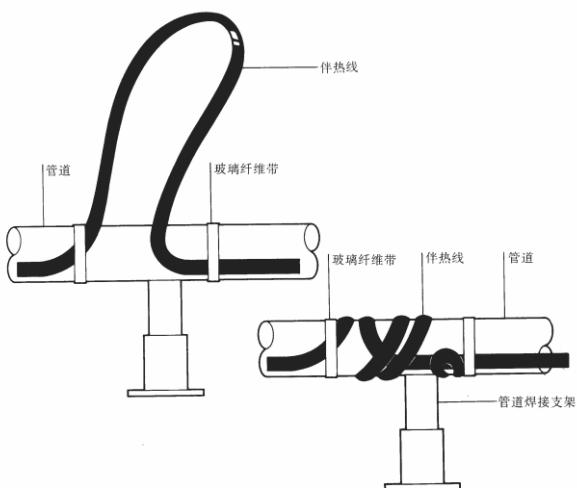
管道在支架安装面处电伴热带的安装
