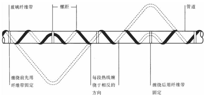
电伴热带在管道上的直铺安装
