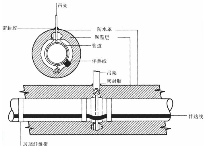
管道在焊接支架部分电伴热带的安装
