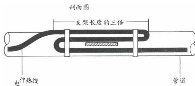
电伴热带在阀门、法兰、泵、仪表等关键部位的安装
