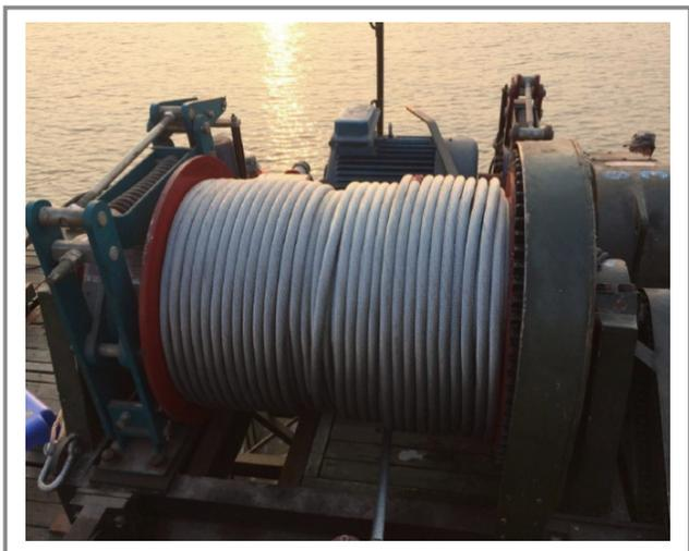
护套材料:根据承力小的电缆可选用综合性能优越的聚氨酯材料作护套,承力大的电缆需考虑电缆剪力对护套的影响,可选用低摩擦系数的护套材料用于降低剪力对护套的影响。
